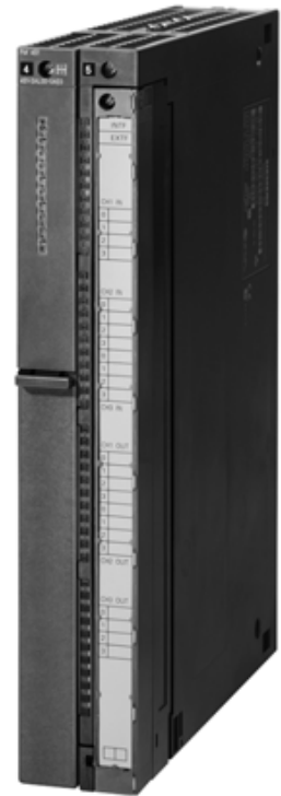
Fig. 2.13 FM451 positioning module
